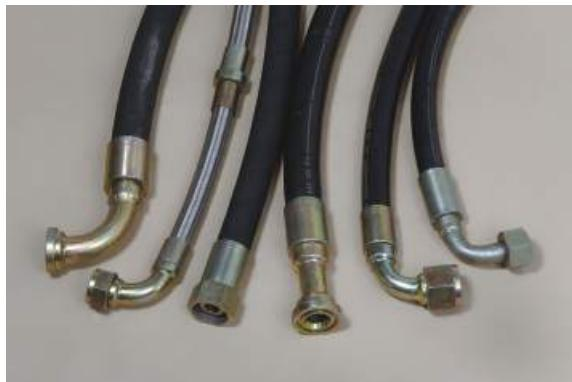
**Gumena creva sa priključcima** - za niski, srednji, visoki vrlo visoki pritisak, creva za protok tečnih goriva, teflonska creva, creva za kočnice koja se koriste kod automobila, traktora, rudarskih i građevinskih mašina.
